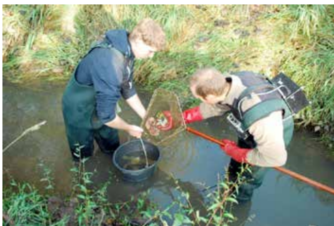
Figuur 3: Draagbaar elektrovistoestel © UHasselt
